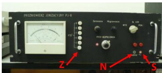
Rys. 7. Fotografia próżniomierza jonizacyjnego PJ-8. Z – przyciski rzędu (zakres) mierzonego ciśnienia, N – wyłącznik chwilowy oraz kontrolka „Nadmiar”, S – wyłącznik sieciowy wraz z kontrolką.
