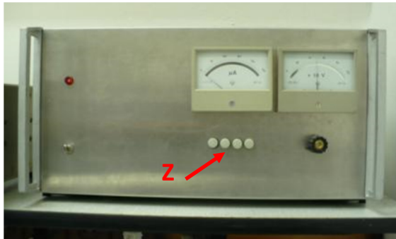
Rys. 6. Fotografia zasilacza pompy jonowej. Z – przyciski zakresu prądu jonowego; od lewego do prawego: 250 \mu\text{A} , 2,5 \text{ mA} , 25 \text{ mA} , 250 \text{ mA} .
