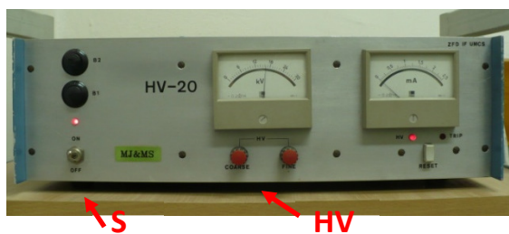
Rys. 9. Fotografia zasilacza wysokiego napięcia HV-20. S – włącznik sieciowy, HV – potencjometry wysokiego napięcia.
