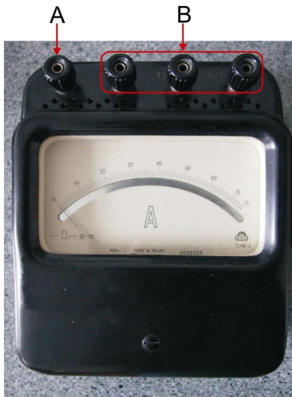
Rys. 10. Fotografia przedstawiająca amperomierz z opisanymi zaciskami: A – „+” amperomierza; B – zaciski o różnych zakresach natężenia prądu: od lewej: 3, 1.5 i 0.75 A odpowiednio.
