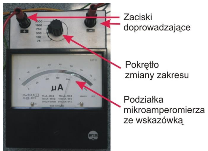
Rys. 8. Fotografia mikroamperomierza do pomiaru natężenia prądu anodowego.
