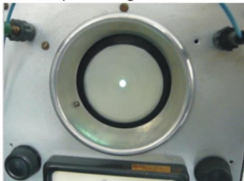
Rys. 11. Obraz plamki elektronowej na ekranie oscyloskopu przed i po zogniskowaniu.
