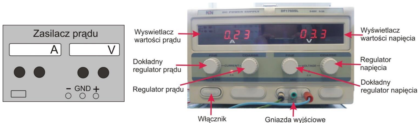
Rys. 6. Schemat i fotografia zasilacza prądu DF1760SL
