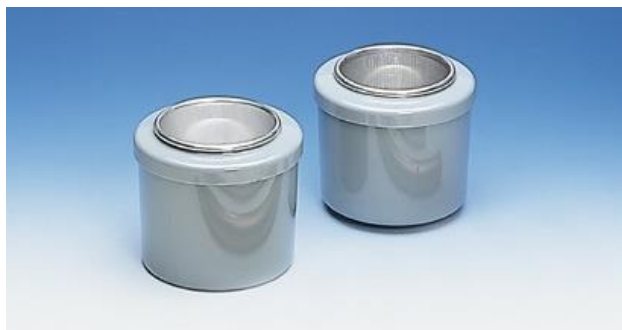
Rys. 2 Kalorymetr I i II, każdy o pojemności 500ml. Jeden z kalorymetrów posiada specjalne wgłębienie wewnątrz do mocowania pręta
