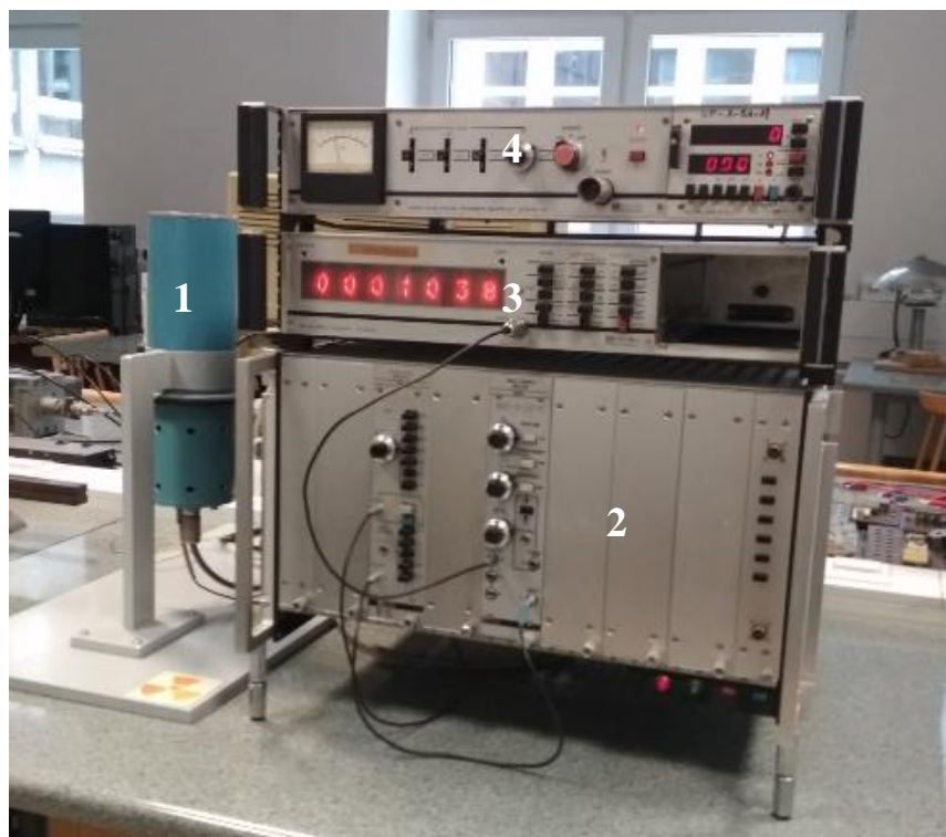
Rys. 2. Zdjęcie aparatury wykorzystywanej w eksperymencie: 1– głowica scyntylatora, 2 – wzmacniacz i jednokanałowy analizator amplitudy, 3 – przelicznik impulsów, 4 – zasilacz napięcia
