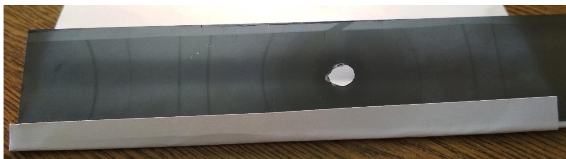
Rys. 5 Debajogram - wywołany i utrwalony pasek światłoczułego filmu (mocowany wewnątrz kasety) ustawiony na papierowej podstawie. Widoczne są ciemne prążki dyfrakcyjne.
