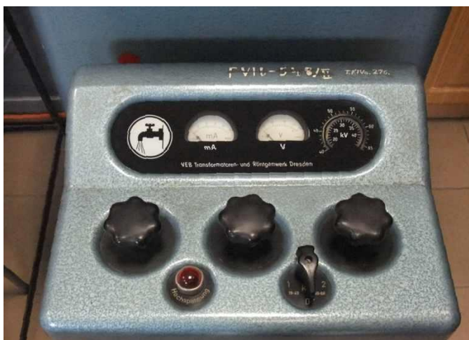
Rys. 2. Tablica sterująca zasilacza oraz schemat tablicy: 1 - regulator prądu anodowego lampy rentgenowskiej, 2 - wyłącznik i regulator napięcia zasilania (220 V), 3 - dokładny regulator wysokiego napięcia (WN), 4 - lampka sygnalizacyjna WN, 5 - skokowy regulator WN, 6 - wskaźnik przepływu wody chłodzącej, 7 - miliamperomierz (miernik natężenia prądu anodowego lampy), 8 - miernik napięcia zasilania (220 V), 9 - wskaźnik WN.
