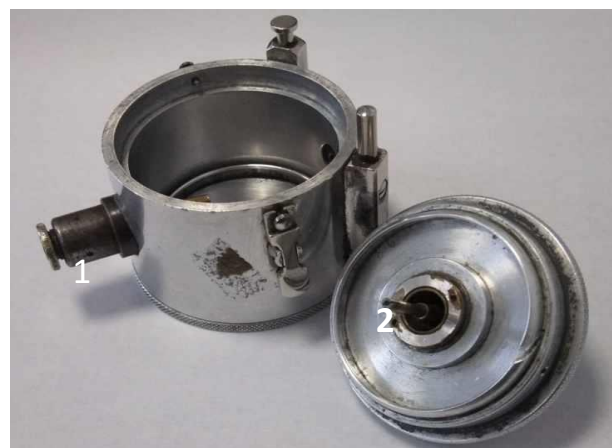
Rys. 4. Widok kasety wewnątrz. 1- kolimator, 2- uchwyt na kapilarę
