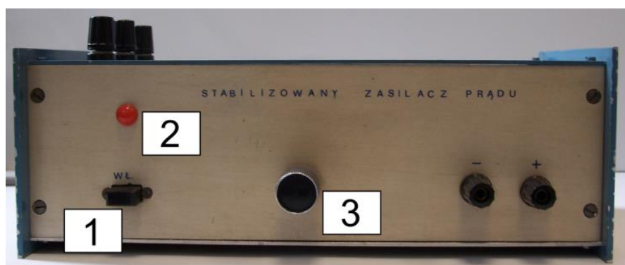
Rys. 5. Stabilizowany zasilacz prądu: 1 – włącznik sieciowy, 2 – lampka sygnalizująca działanie urządzenia, 3 – pokrętko regulacji prądu.
