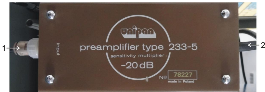
Rys. 9 Fotografia przedwzmacniacza 233-5: 1- wejście, 2- wyjście.
