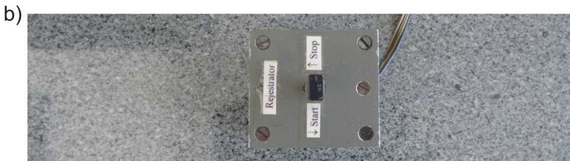
Rys 13b. Fotografia przełącznika 14 stanowiącego przedłużenie przycisku oznaczonego numerem 6.
