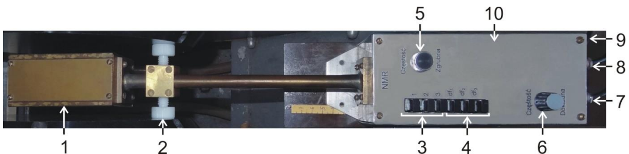
Rys. 3 Fotografia sondy NMR oraz obudowy generatora wysokiej częstotliwości z detektorem i wzmacniaczem sygnału.
